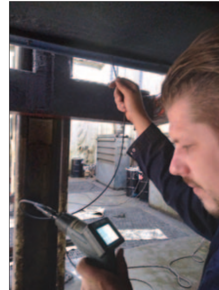
Met de endoscoop worden de holle ruimtes geïnspecteerd
