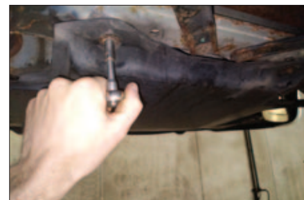
Op de brug worden eerst waar nodig de panelen verwijderd.
