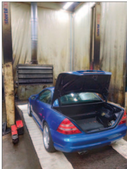
Na het reinigen van de auto wordt deze weer op zijn wielen gezet en in een droge hal gereden waar hij 48 uur moet drogen
