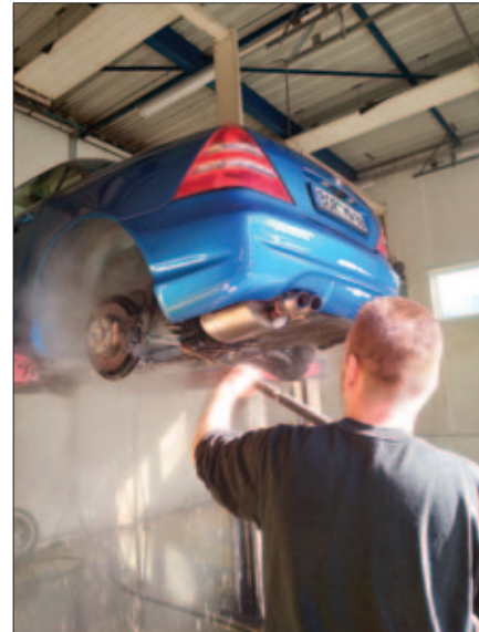
Waarna de losse roest wordt verwijderd met de hogedrukspuit
