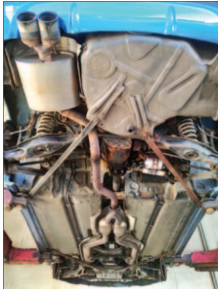
Zo door de jaren heen heeft zich aardig wat oppervlakeroest verzameld. De losse roest wordt eerst verwijderd.
