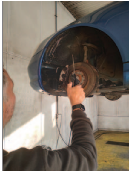
Zit er veel roest, dan wordt deze eerst behandeld met een oplosmiddel
