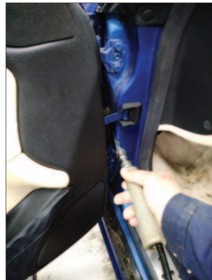
Waarna de losse roest wordt verwijderd met de hogedrukspuit
